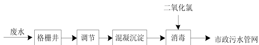
图 4-1 废水处理站工艺流程图
