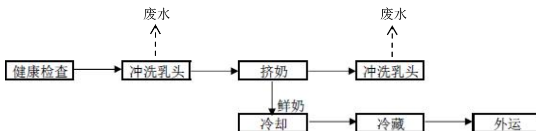
图 3-7 牛奶生产流程图
