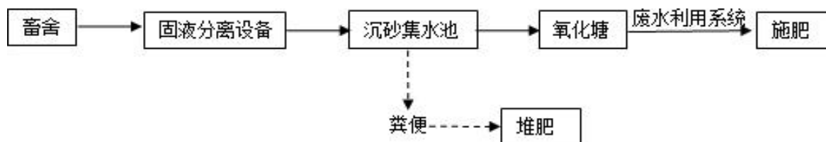
图 4-1 环评期及实际污水工艺流程图
