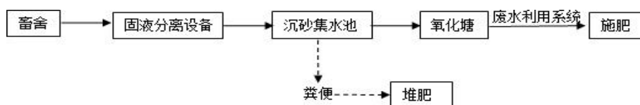
图 3-8 污水工艺流程图
