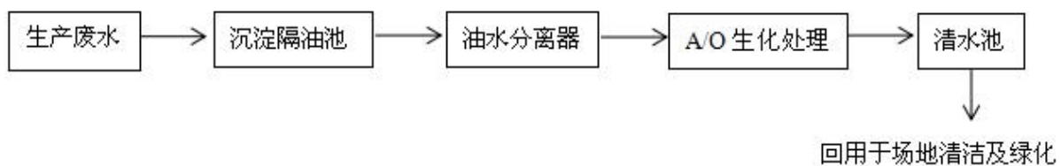
图 3-3 生产废水处理工艺流程图
