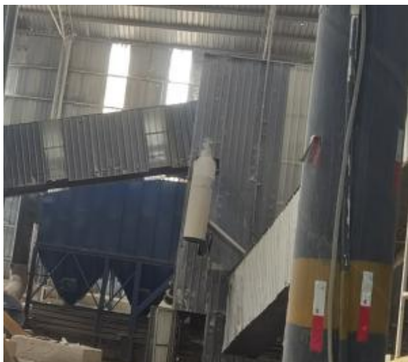
振动筛密闭间（一筛）及除尘器
