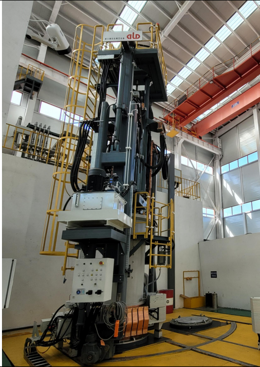
真空自耗电弧炉
