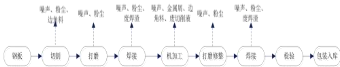
图 2-1 支撑座工艺流程及产污环节图
