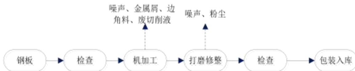
图 2-3 铜套工艺流程及产污环节图
