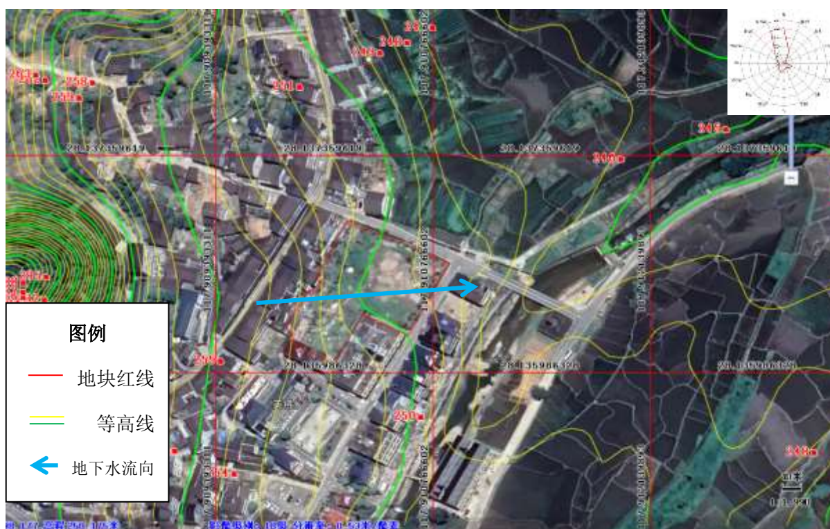
图 3.2-2 依据地形等高线推测的地下水流向图
