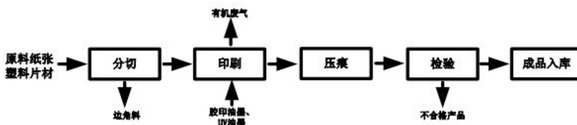
图 3-4 项目生产工艺流程及产污节点图
