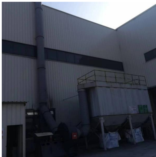
三个混砂机通过两个排气筒排放
