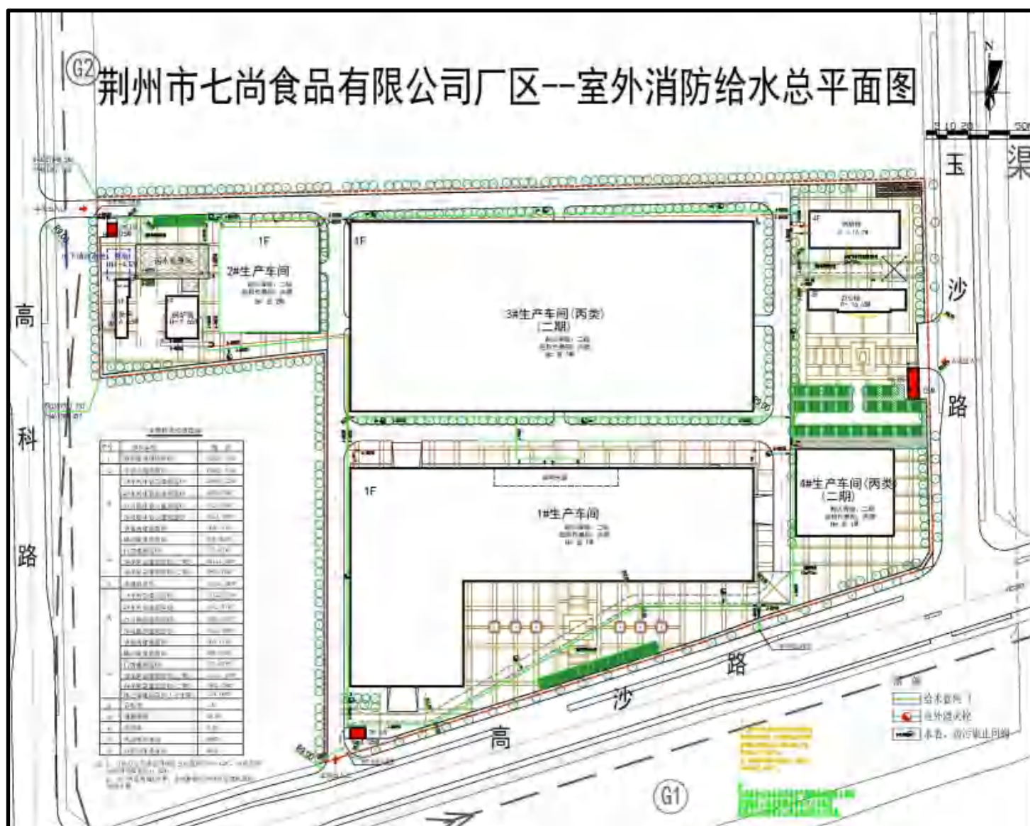
附图 5 厂区给水管网分布示意图
