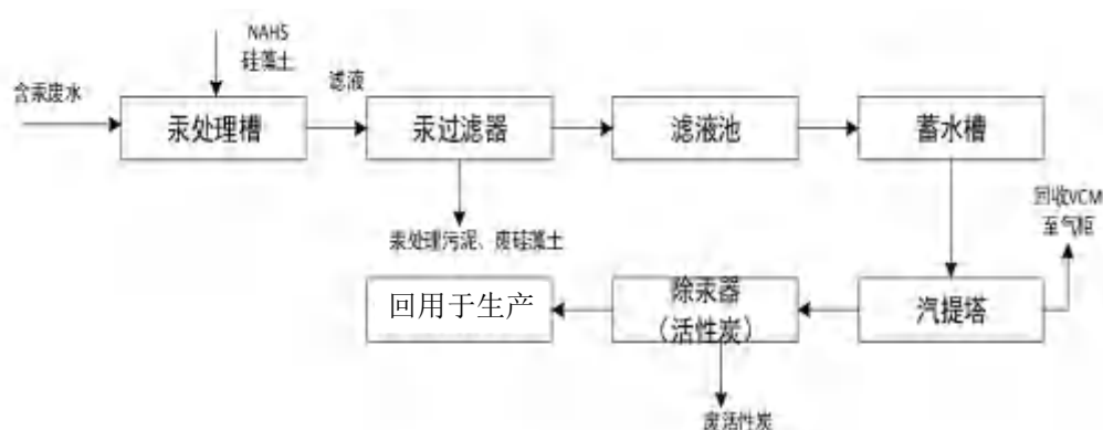
图 3.3-2 含汞废水预处理工艺流程图
