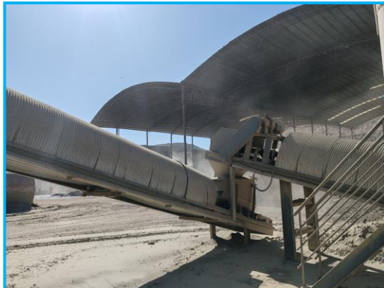
旋风除尘器+布袋除尘器+1#排气筒
