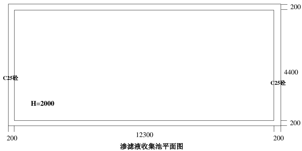
图 4-2 渗滤液收集池平面图 单位：mm
