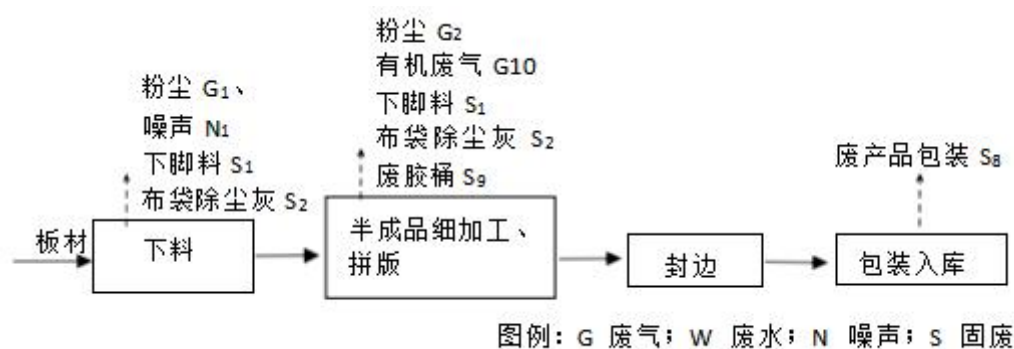
图 2-3 板式木门生产工艺及产污节点图
