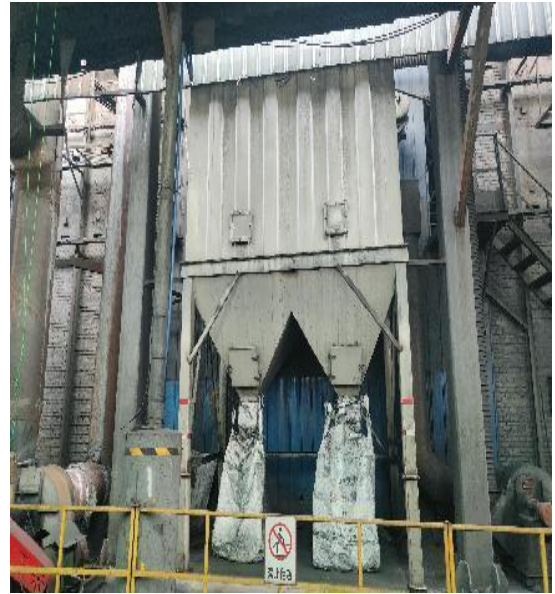
破碎、筛分工序布袋除尘器
