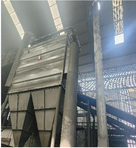
破碎、筛分工序布袋除尘器
