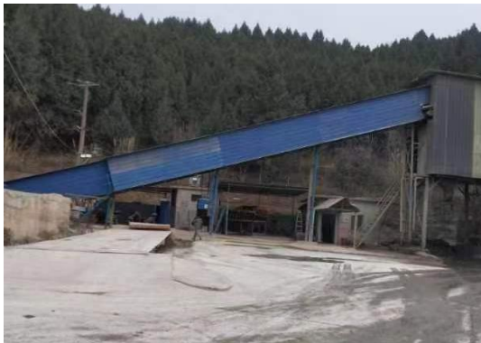
图 3-4 物料输送带封闭
