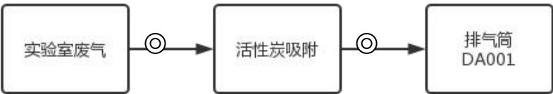
图 3-1 废气处理和排放示意图 ⊙ 监测点位
