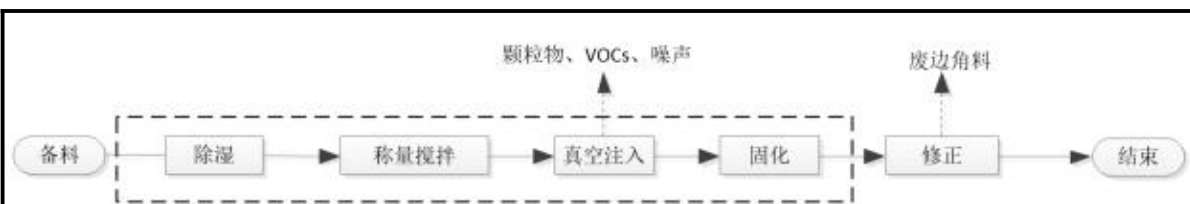
图 2-4 互感器（塑料结构件）生产工艺流程图
