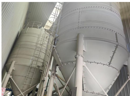
粉煤灰、水泥储罐
