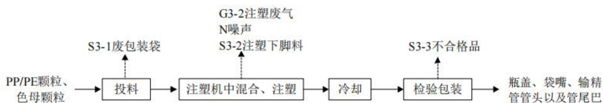
图 2-5 瓶盖、袋嘴、输精管管头以及管尾巴生产工艺流程及产污环节示意图
