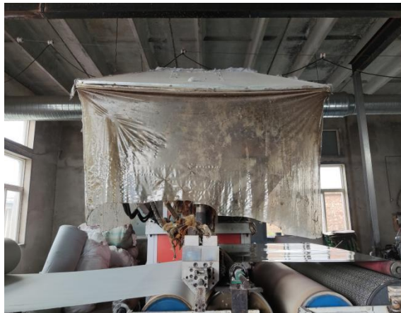
图 2 复合工序集气罩
