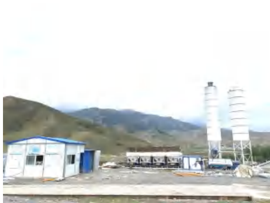
图 8.3 拌合站密闭拌和、场地硬化、料仓围挡
