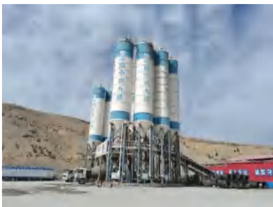
图 8.3 拌合站密闭拌和、场地硬化、料仓围挡
