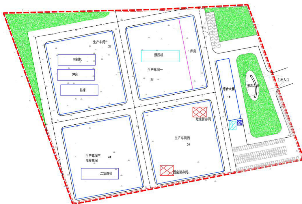
图 3-2 环评阶段总平面布置图
