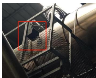
烟密度测量模块（测试区）
