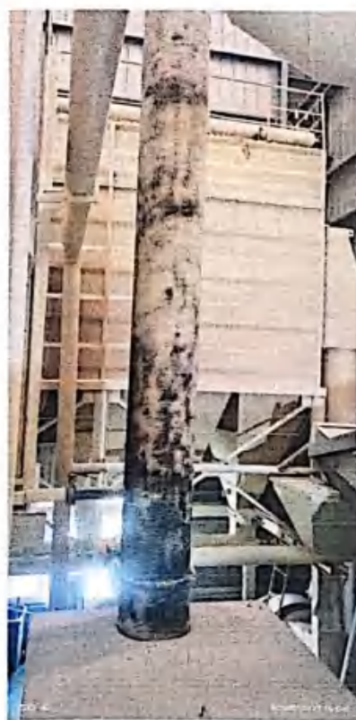
图 3-3 改造后新增 4 套布袋除尘器
