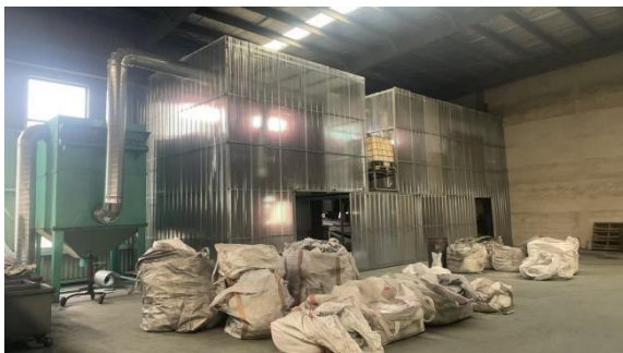
图 5 配料、搅拌工序废气密闭收集装置及治理设施（布袋除尘器）
