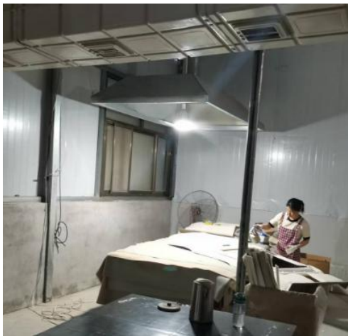
图 2 喷胶工序集气罩
