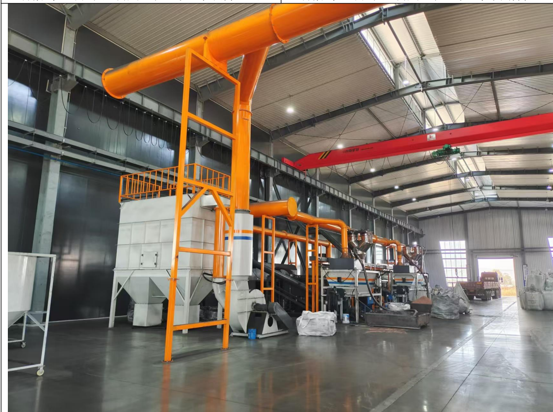
铜饼生产线—布袋除尘器
