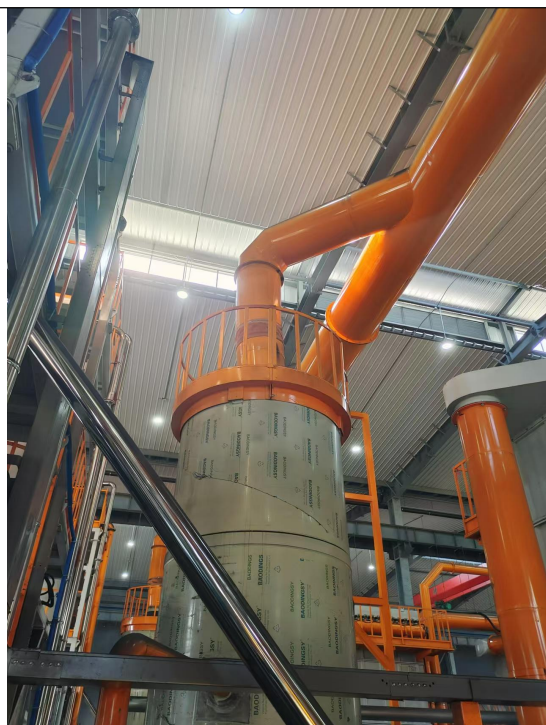
铜箔等原料综合利用生产线—水喷淋除尘
