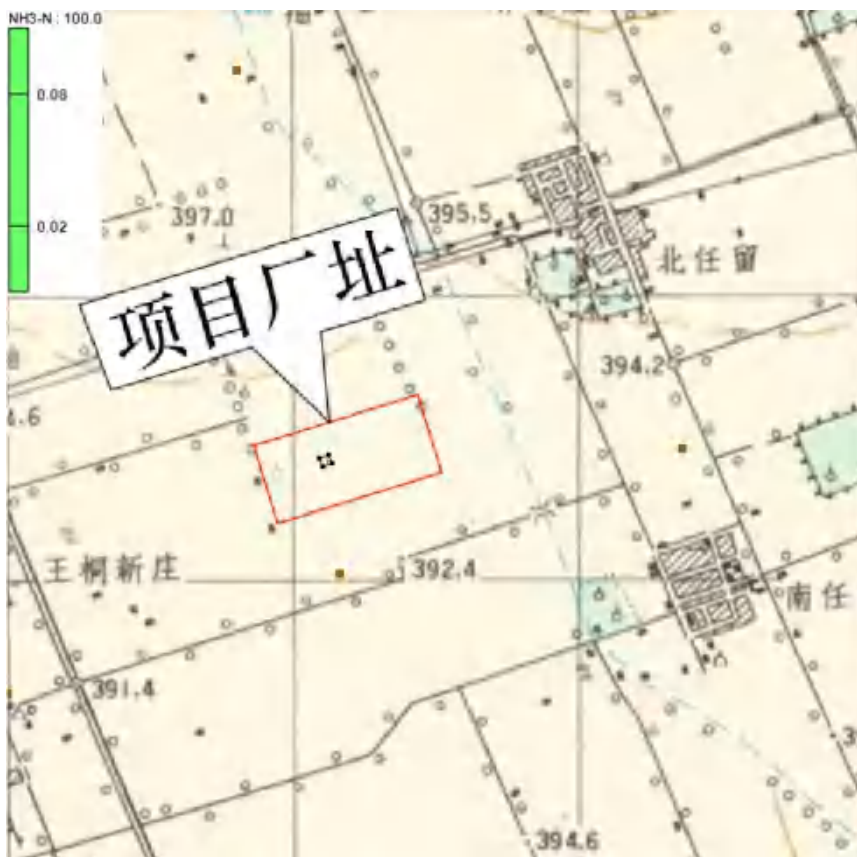
图 5.4-12 (情景二) 氨氮渗漏 100 天影响范围图
