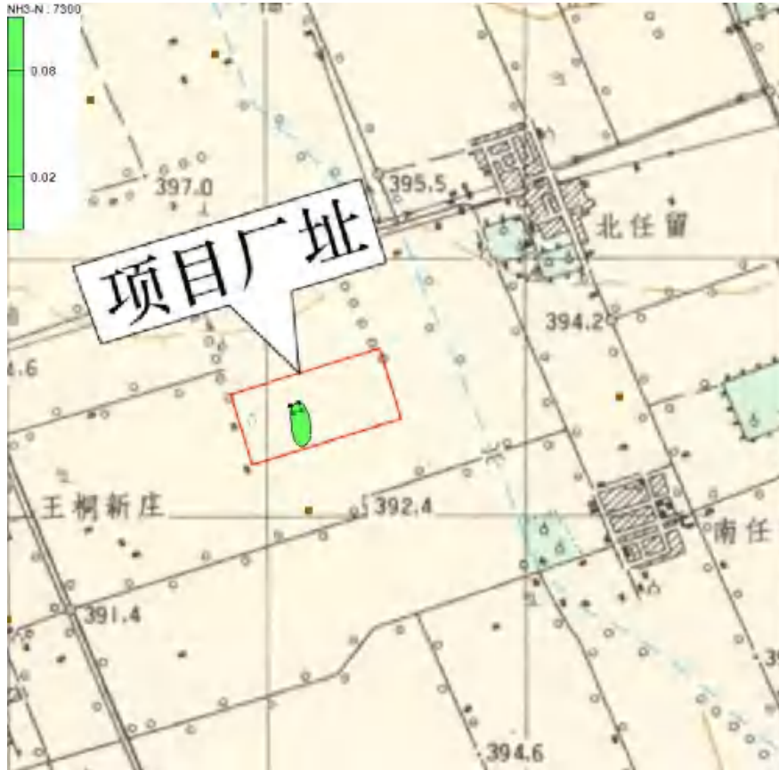
图 5.4-12 (情景二) 氨氮渗漏 7300 天影响范围图
