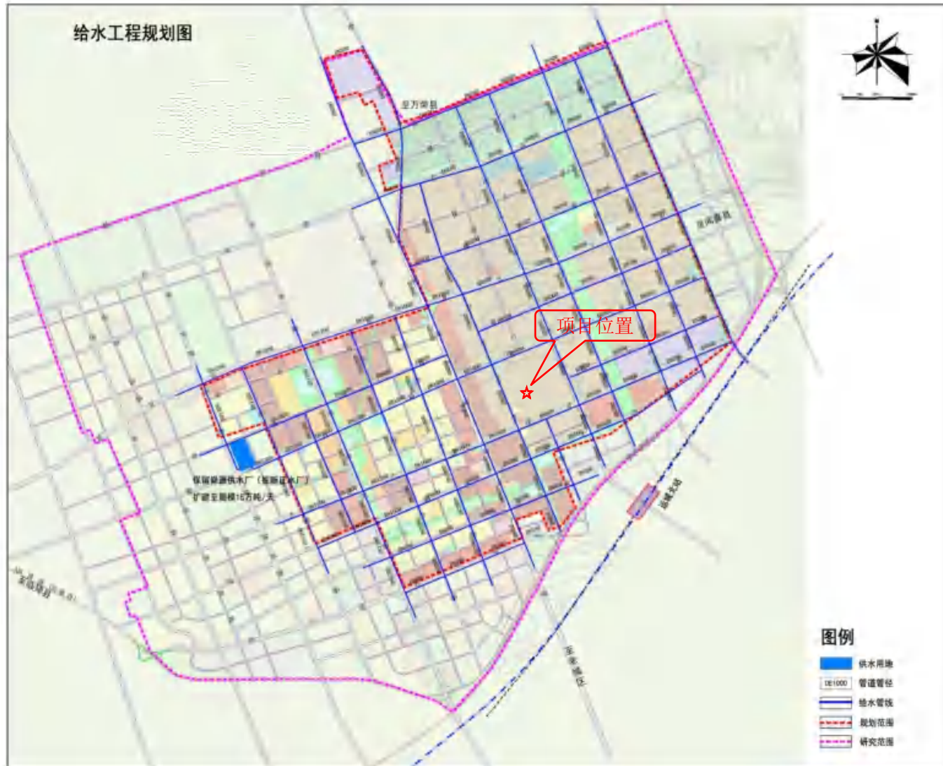
图 1.3-3 开发区给水管网图
