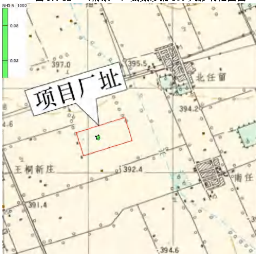
图 5.4-12 (情景二) 氨氮渗漏 1000 天影响范围图
