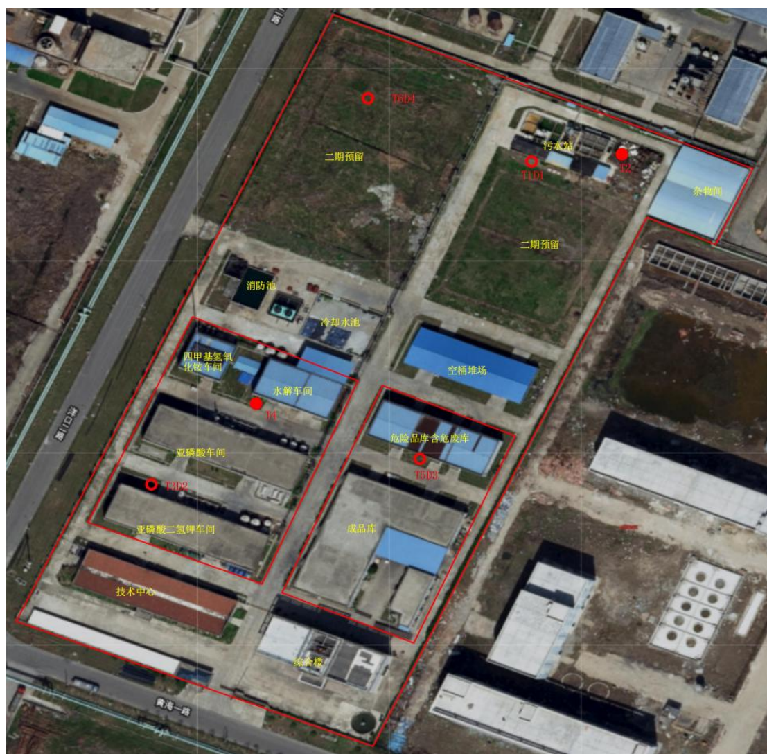
图 6.1-1 土壤和地下水布点图
