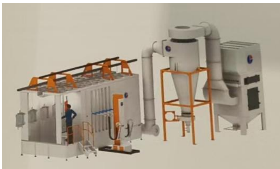
图 2-3 项目喷粉工艺示意图
