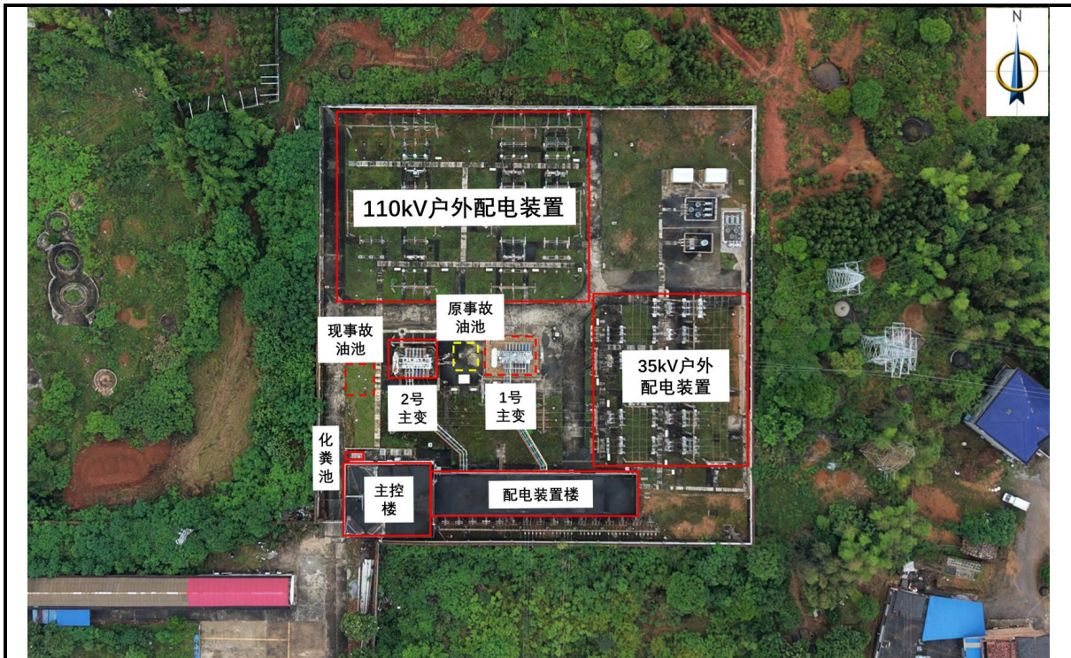
图 4-2 大瑶 110kV 变电站平面布置图
