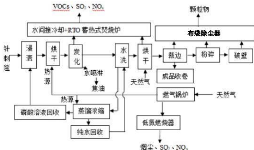
图 3-4 W 型活性炭纤维生产线工艺流程图
