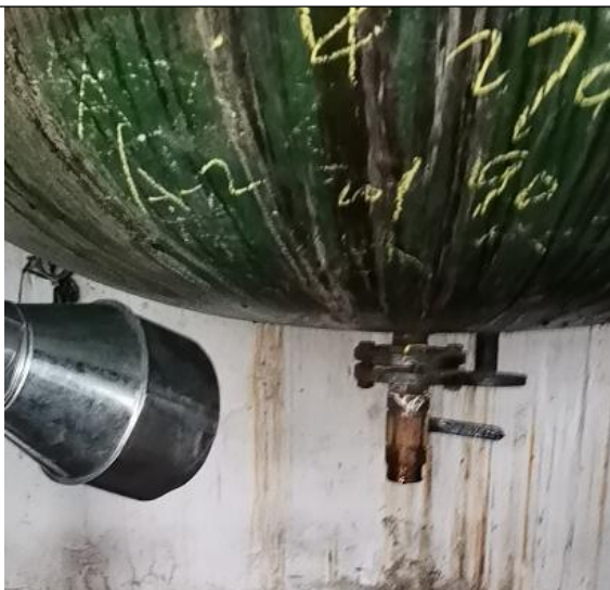
反应釜下料口集气管道
