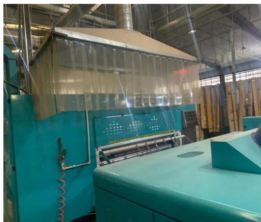
印刷工序集气罩
